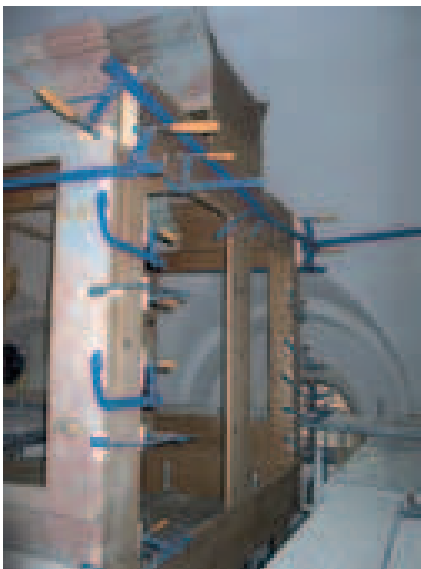
Varhanní skříň. Klížení rámové konstrukce. / Organ case. Gluing the framework. Foto Pavel Hanč
