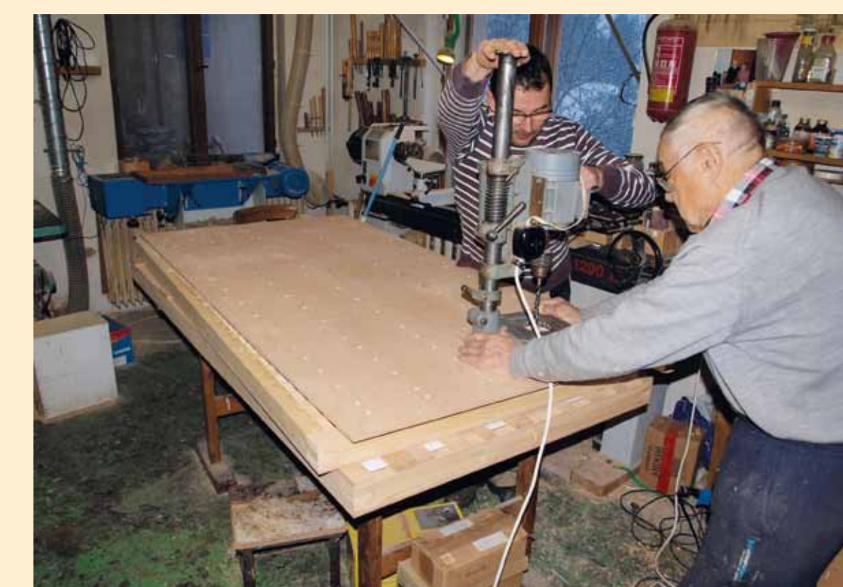
Vrtání tónových otvorů pedálové vzdušnice.
