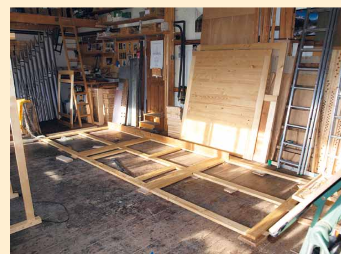
Připravený půdorysový rám varhan.
